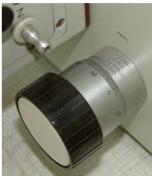
Rys. 3. Śruba mikrometryczna nastawy długości fali świetlnej (nastawiona na 690 nm).
