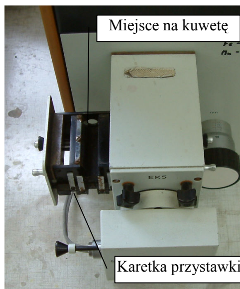
Rys. 4. Przystawka pomiarowa do kuwet 5 cm.
